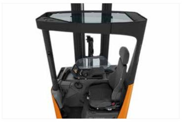
El diseño limpio del mástil y del carro portahorquillas ofrece al operario una visión excepcional de la carga en todo momento, lo que aumenta la productividad y la seguridad.
